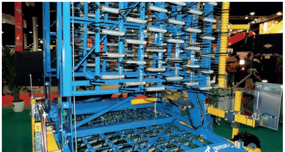
5. kép. Rugós ujjak szögállásának állítási mechanizmusa, rugózási megoldása (a fotó a szerző felvétele)
