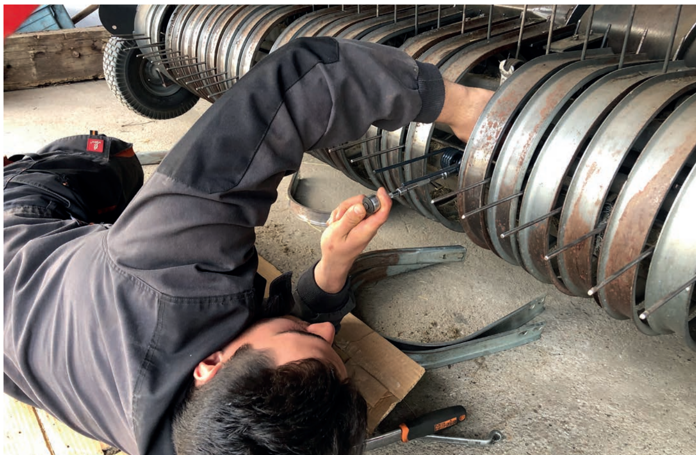
Az ujjak deformációja, törése gyakori hiba, amelynek javítása elengedhetetlen a szezon előtt (a fotók a szerző saját felvételei)
