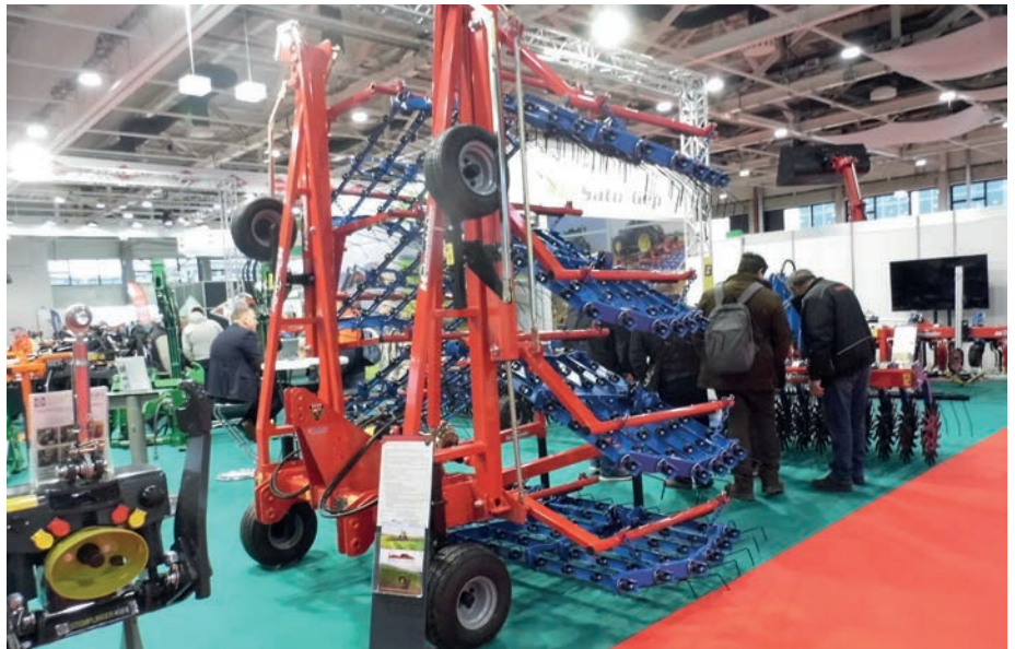
4. kép. Rugótagok láncos flexibilis felfüggesztése (a fotó a szerző felvétele)
