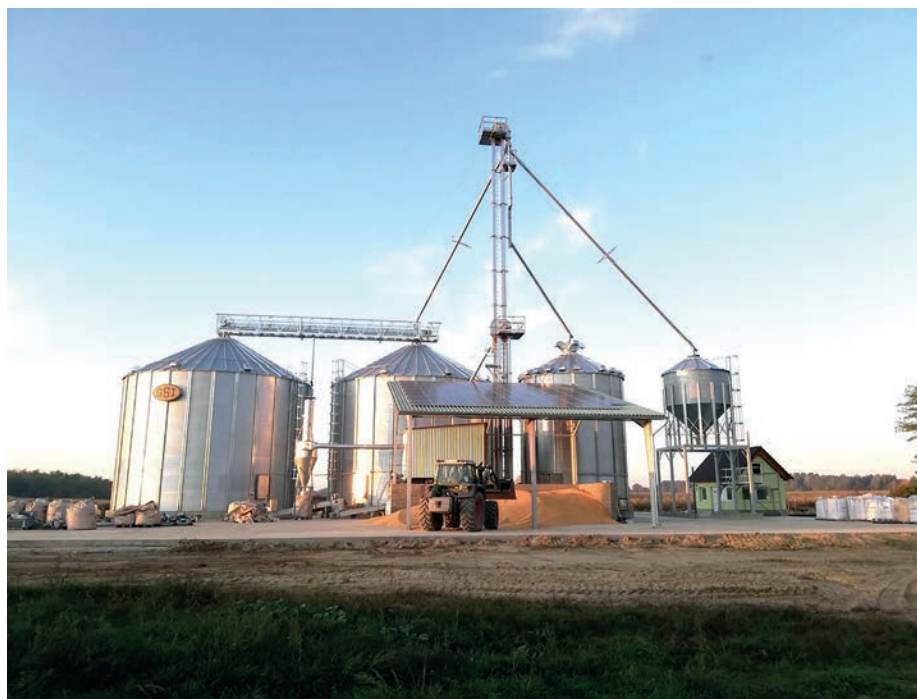
Folyamatos üzemű TopDry tárolótelep sikrotás tisztítóval
