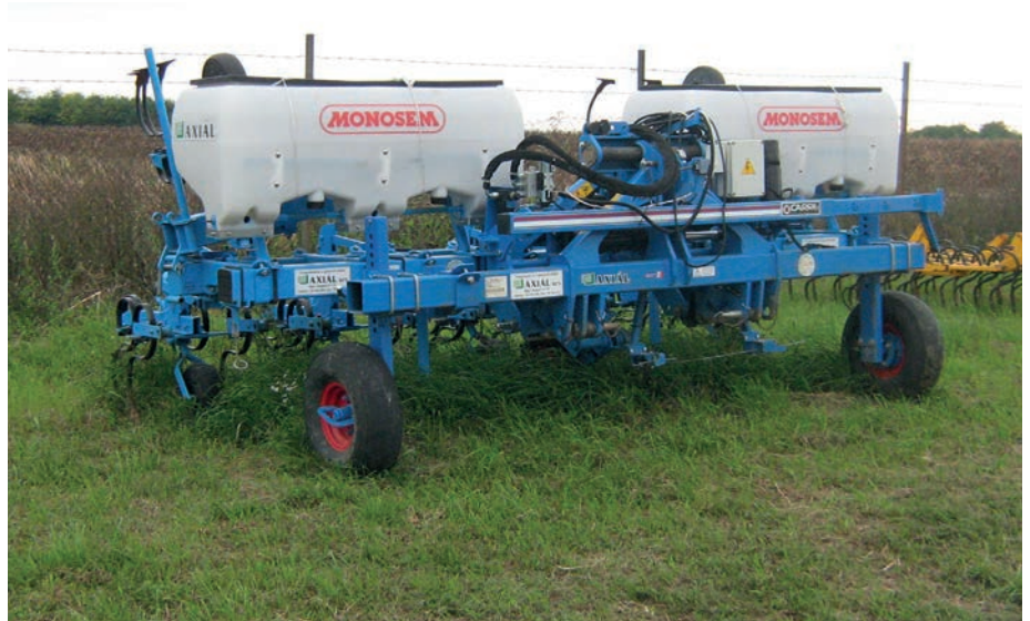
9. kép. Elektromos vezérlésű sorközművelő (fotó: a szerző felvétele)
