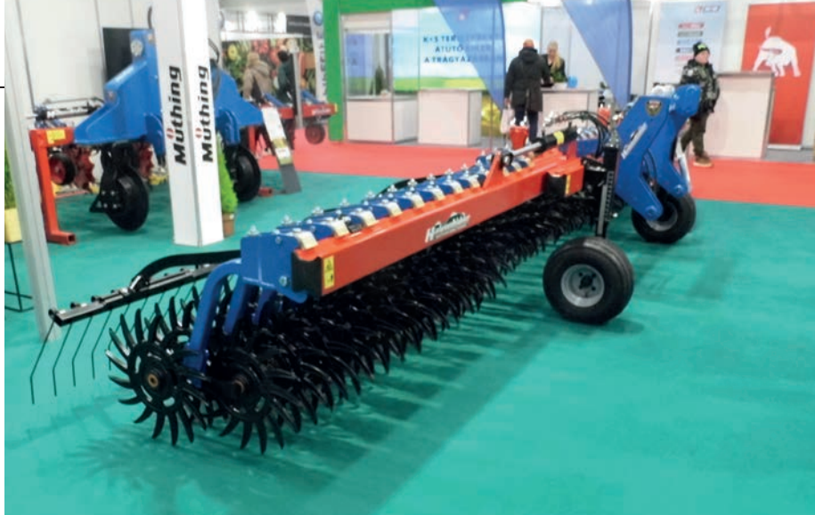
6. kép. Küllőskapa-konstrukció munkahelyzetben (a fotó a szerző felvétele)
