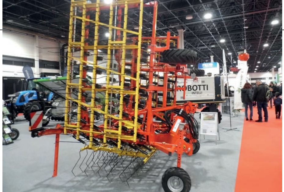
3. kép. Félig függesztett gyomfésű szállítási helyzetben (a fotó a szerző felvétele)
