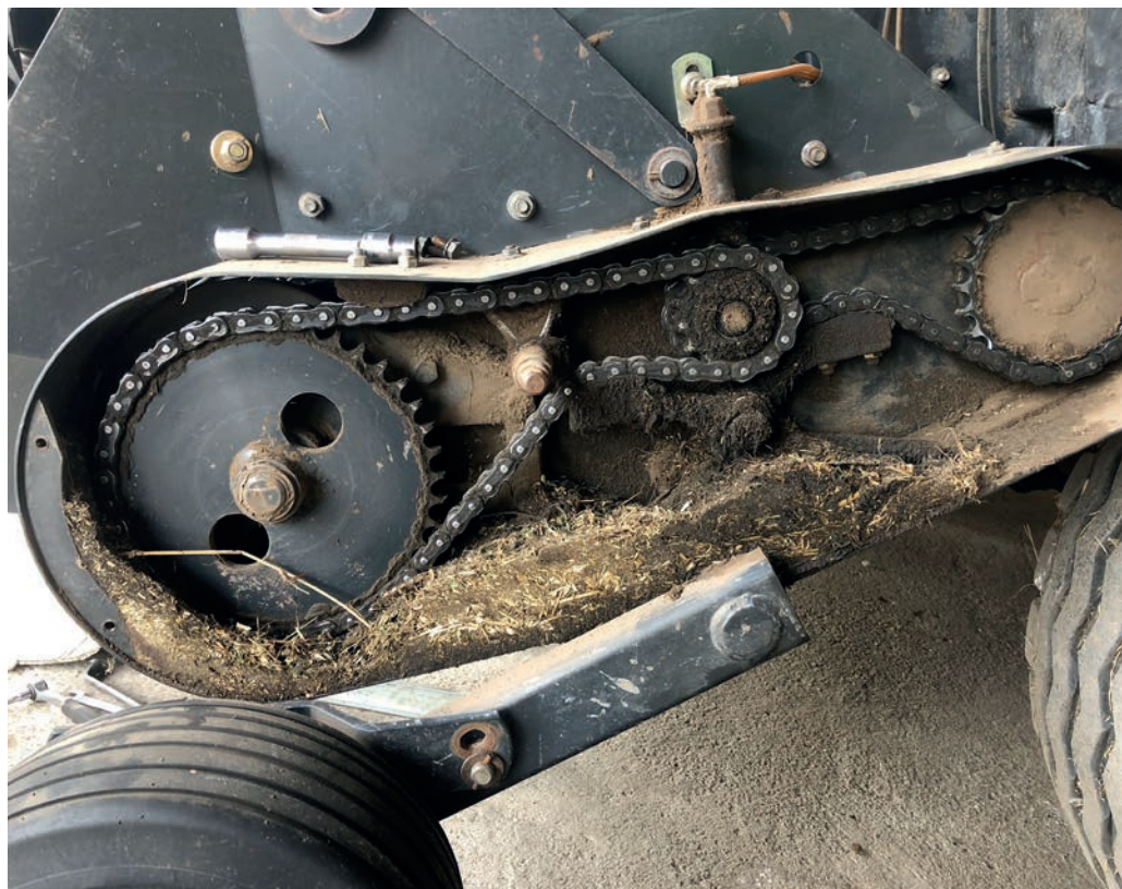
Az alkatrészek állapotának felmérése során a lánchajtás, a láncfeszítők és az olajzóecsetek működésének ellenőrzése sem maradhat el
