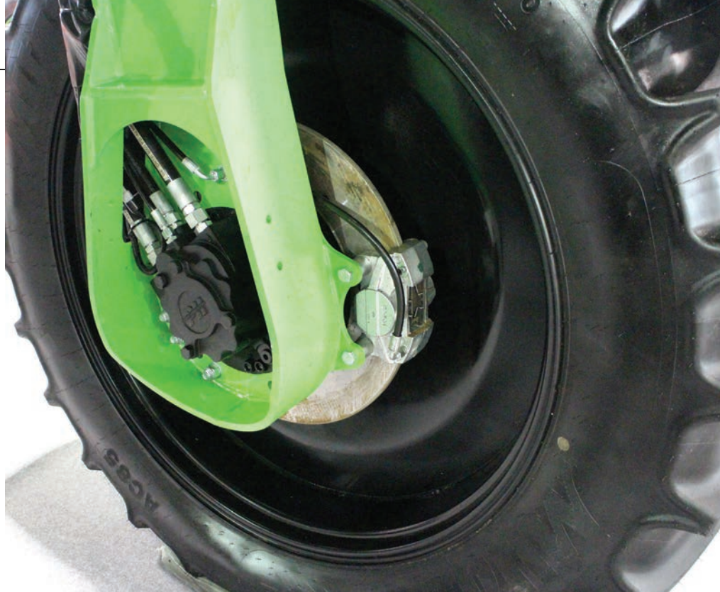
5. kép. Grim 4500 Maxi 10 permetezőgép hidraulikus tárcsafékekkel (a fotó a szerző saját felvétele)
