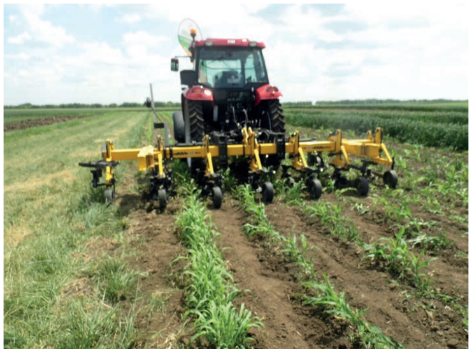
10. kép. Sorközművelés szenzoros érzékelővel szerelt forgóserszámú kultivátorral (a fotó a szerző felvétele)
