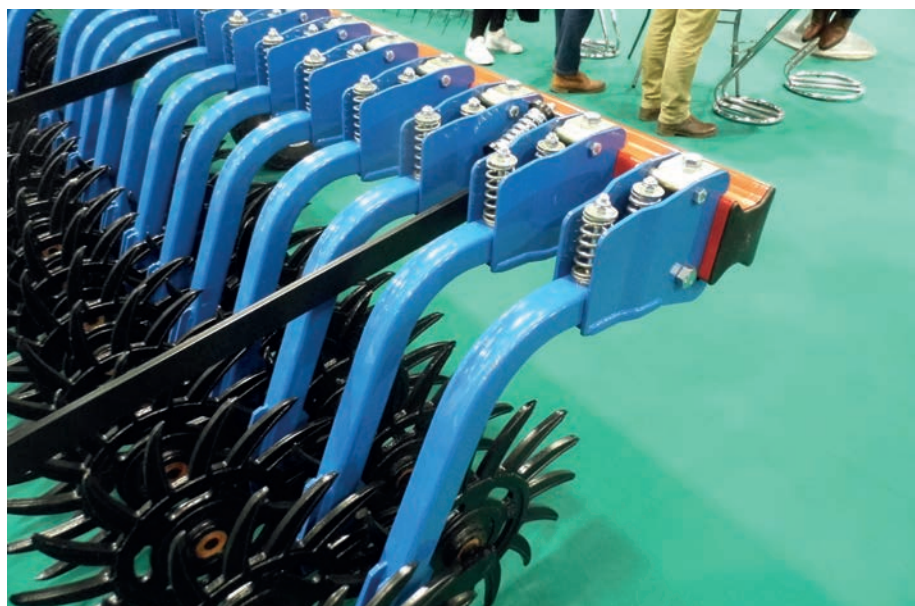
7. kép. Küllős kapa munkaeszköz-felfüggesztése (a fotó a szerző felvétele)
