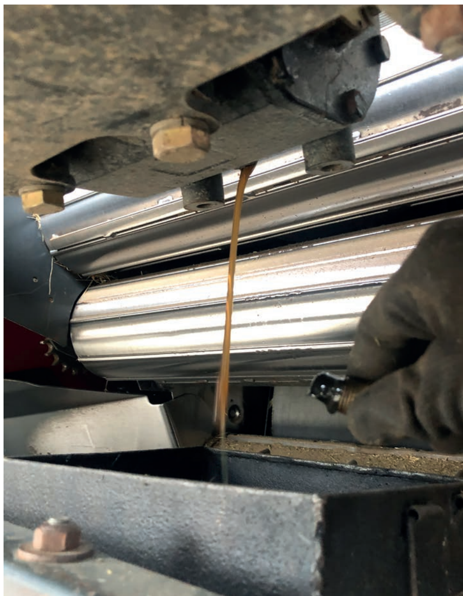
Az olaj minőségét ne csak szemrevételezéssel, hanem a mágneses leeresztőcsavaron megjelenő fémreszelék mennyisége alapján is vizsgáljuk
