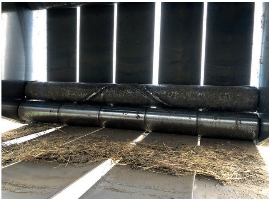
A hevederes bálázók feszítőgörgői és azok csapágyazása a bálázótűzek leggyakoribb forrása
