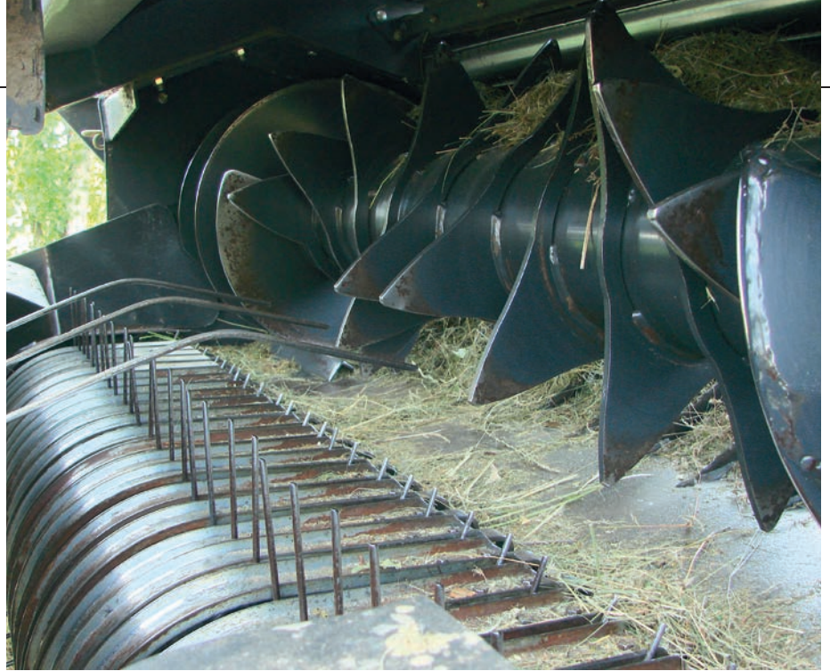
Feltétlenül ellenőrizzük a konzolcsigák és a rotorok csapágyazását
