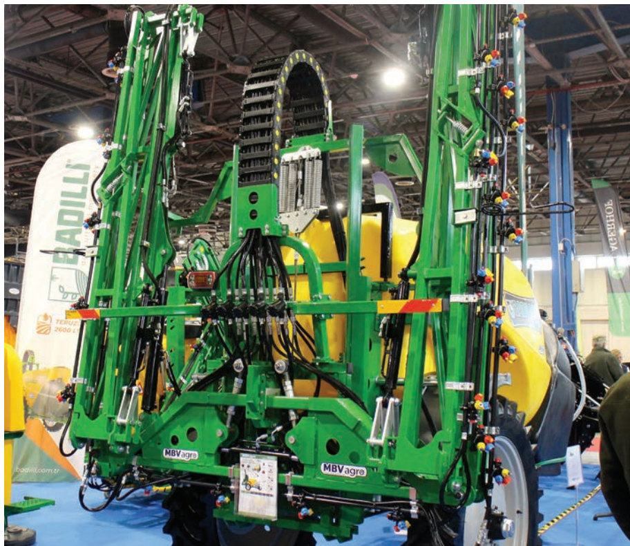
1. kép. Badilli BR 1000-16 típusjelzésű, új vontatott keretes permetezőgép (a fotó a szerző saját felvétele)
